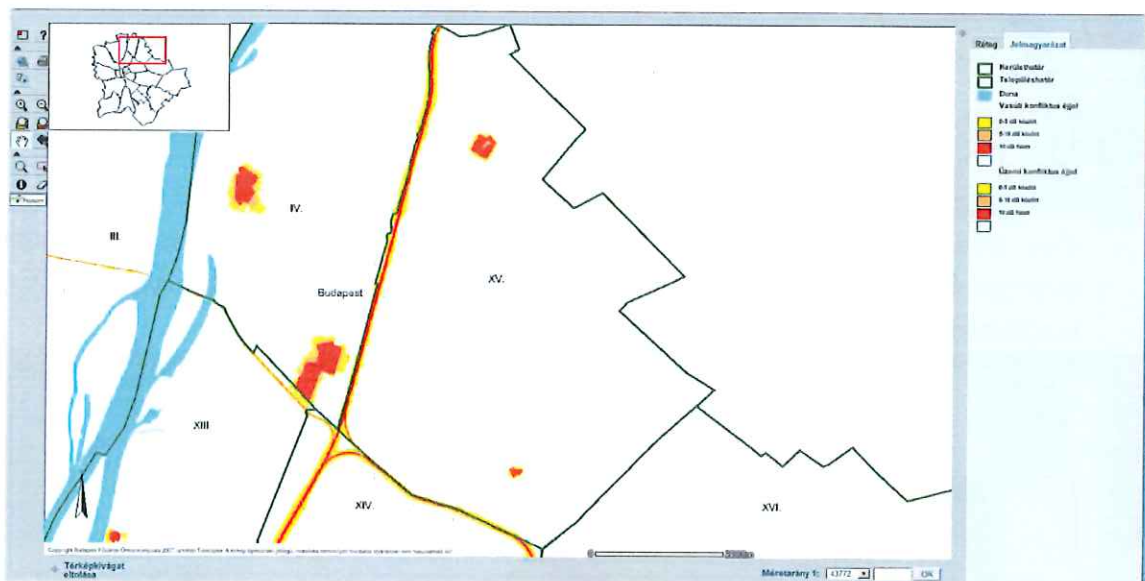
4. ábra. Budapest stratégiai zajtérképe, konfliktustérkép – üzemi és vasúti zajterhelés éjjel a XV. kerületben. (Forrás: terkep.budapest.hu)
