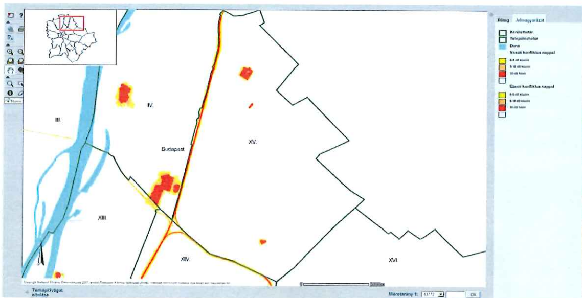
3. ábra. Budapest stratégiai zajtérképe, konfliktustérkép– üzemi és vasúti zajterhelés nappal a XV. kerületben. (Forrás: terkep.budapest.hu)
