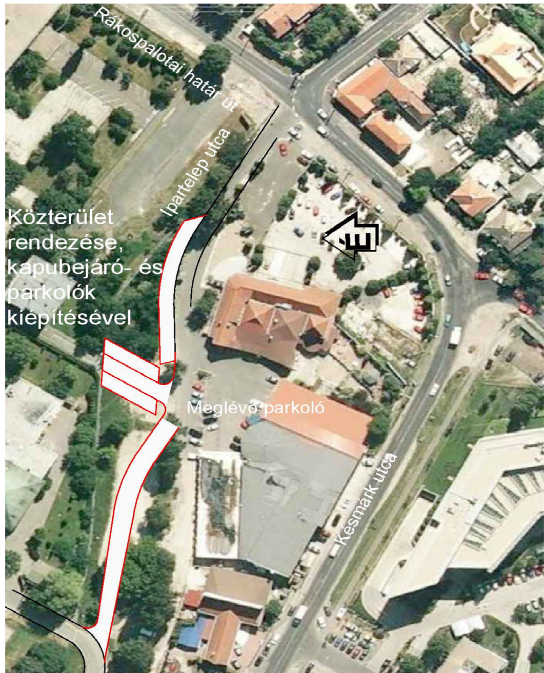
8.5.11. Késmárk utca 30. sz. előtti burkolatlan terület aszfaltozása, parkoló kialakítással
